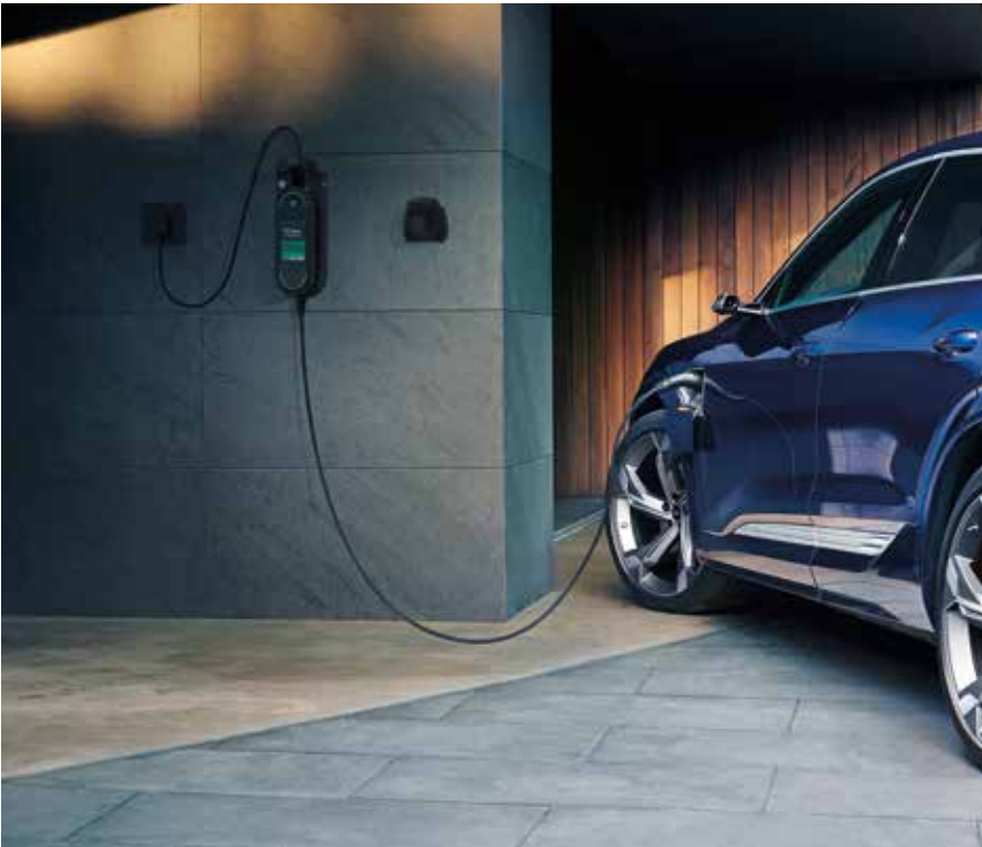
Audi e-tron ist startklar für netzdienliches Laden: Im Forschungsprojekt mit GISA wurde durch gezielte Kommunikation zwischen E-Auto und Netzbetreiber der Ladevorgang dynamisch gesteuert.
